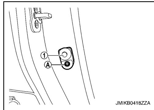
2. 断开车门开关线束插头(←), 然后拆下车门开关。
